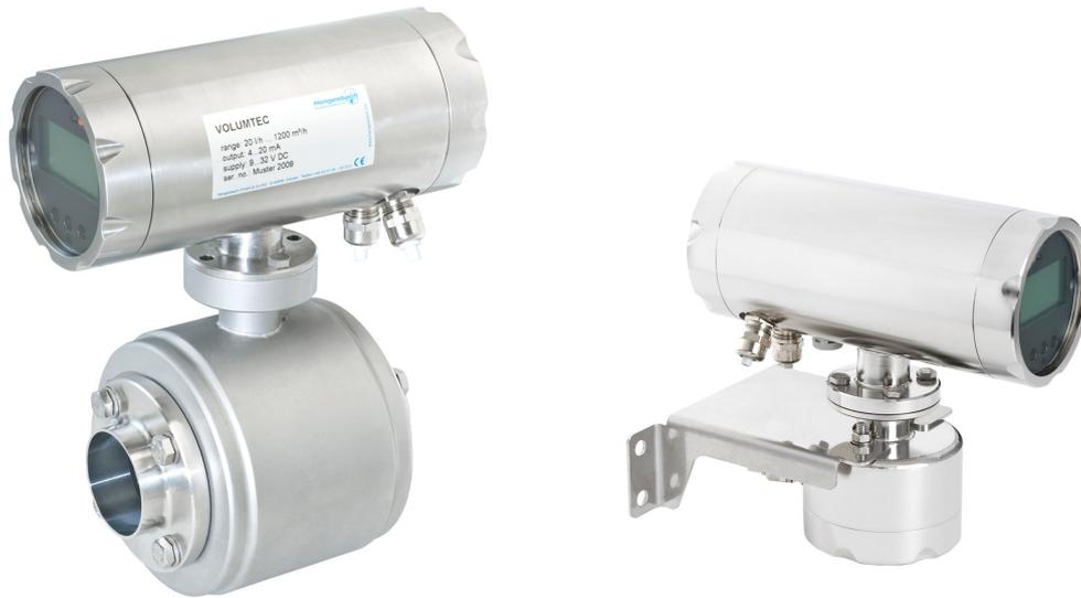
Ausführungsbeispiele: VOLUMTEC in Kompakt-Version mit Prozessanschlussadapter Schweißstutzen für Rohre nach DIN 11850 (Nutflansch nach DIN 11864-2 Form A zum Anschweißen an Rohre nach DIN 11866 - Reihe A) und VOLUMTEC in Getrennt-Version ohne Messwertaufnehmer
