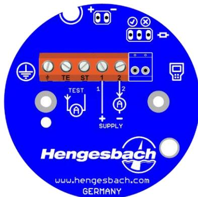
Abbildung 1: Platine mit den Anschlussklemmen im Kopf des Transmitter-Gehäuses
